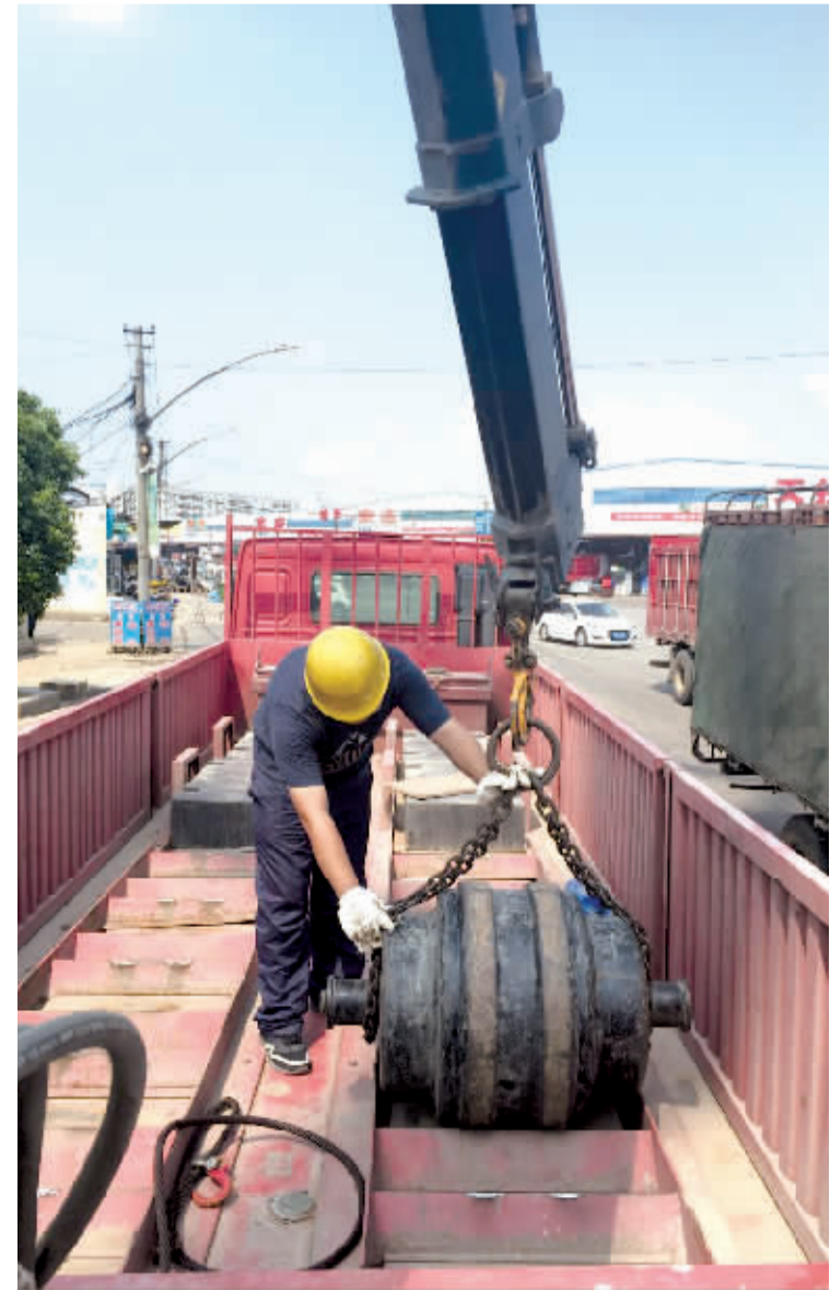
市度量衡管理所检定人员用1000kg标准砝码检定电子汽车衡的称重
