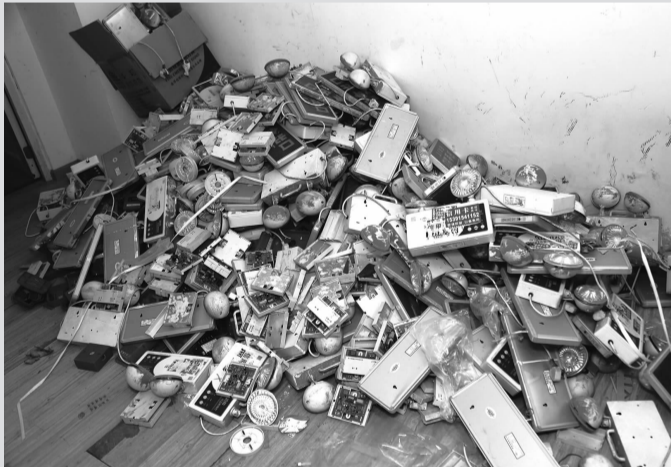
蓝巢逸品小区里换下的破损消防指示标识和应急灯
