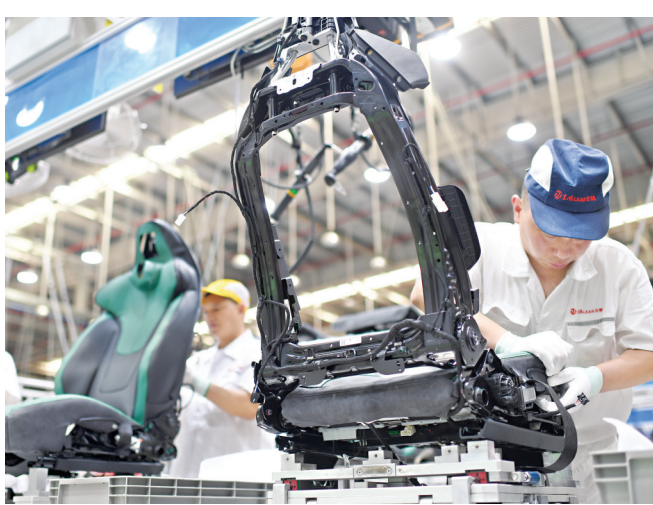
东风李尔武汉工厂车间,工人正在安装路特斯新能源车的座椅。
