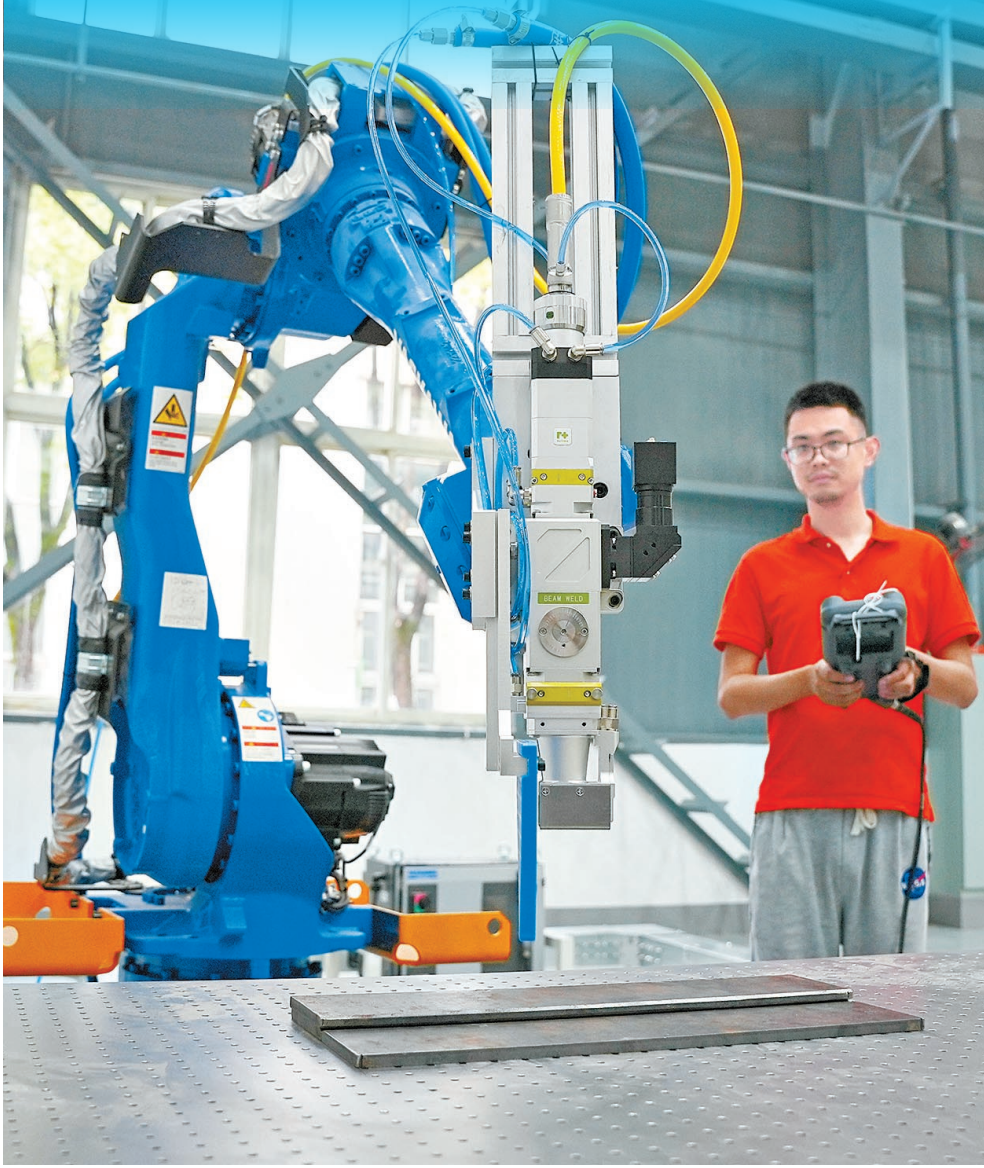
华工科技“基于工业大模型的智能焊缝引导与识别检测系统”，正在应用于焊缝跟踪场景。
