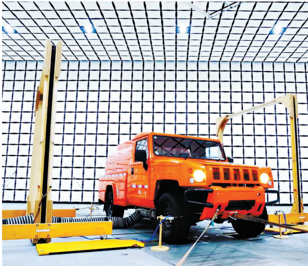
武汉检验中心内，车辆进行电磁兼容性测试。
