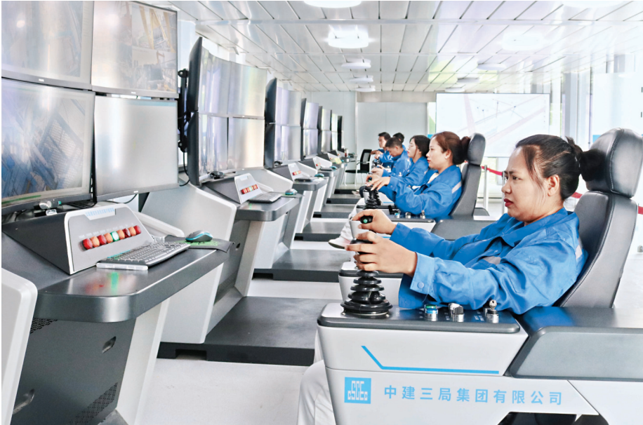
在汉芯公馆智能建造试点项目工地,塔机司机在地面控制室操控塔吊。
