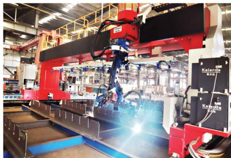
武汉双柳生产基地最新引进的龙门式智能焊接机器人正在焊接隔板单元件。
