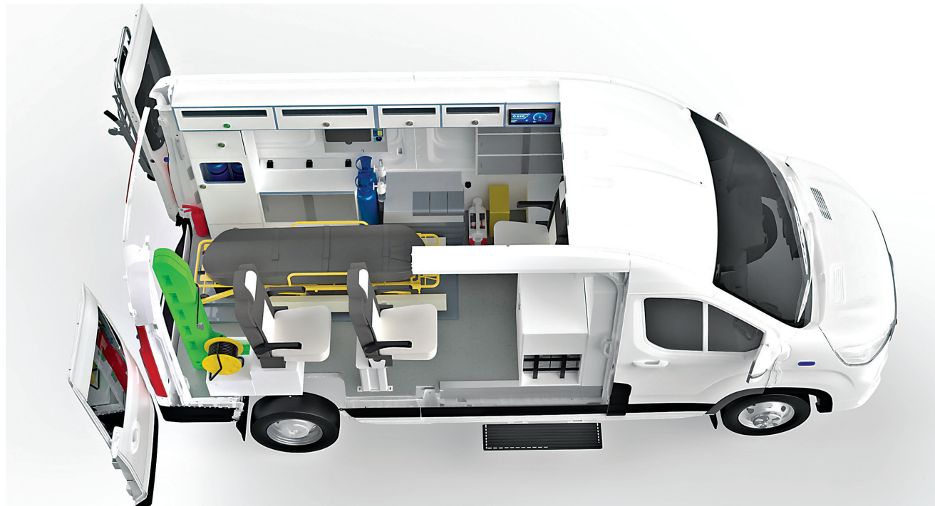
AI急救车内部柜体中装有AI服务器，使用纯电底盘。
