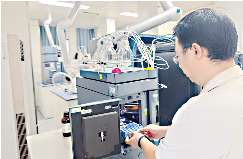
检测人员将提取物导入离子淌度高分辨质谱仪进行分析。
