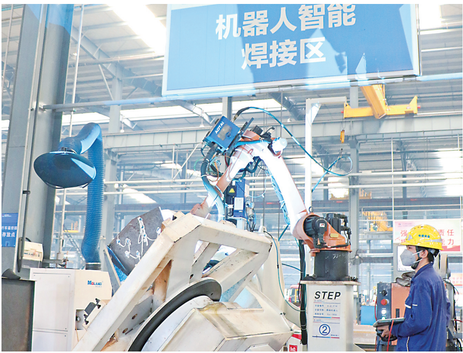
焊接机器人正舞动机械臂,焊接起两块金属板。
