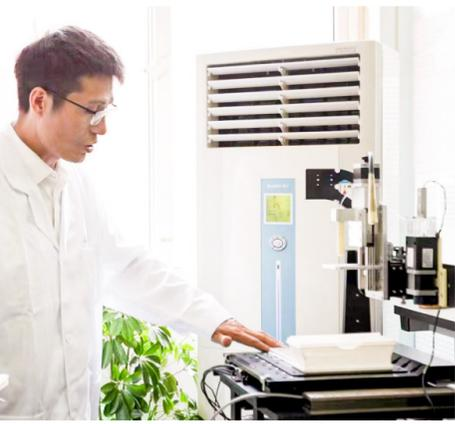
赵信毅率团队加紧高精度精密细胞挑克隆设备攻关。
