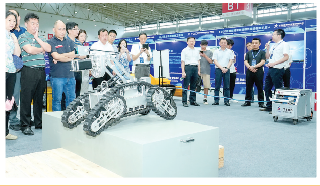
中仪股份研发的全球首款多形态履带式箱涵检测机器人。
