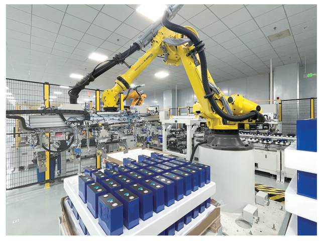
中储科技生产线上,自动化机械臂进行电芯上料。
