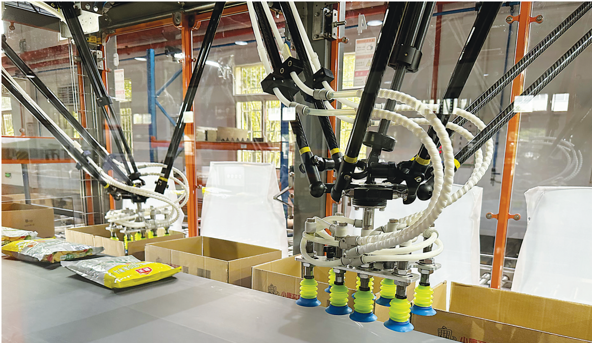
分拣装箱机器人正在进行装箱测试。
