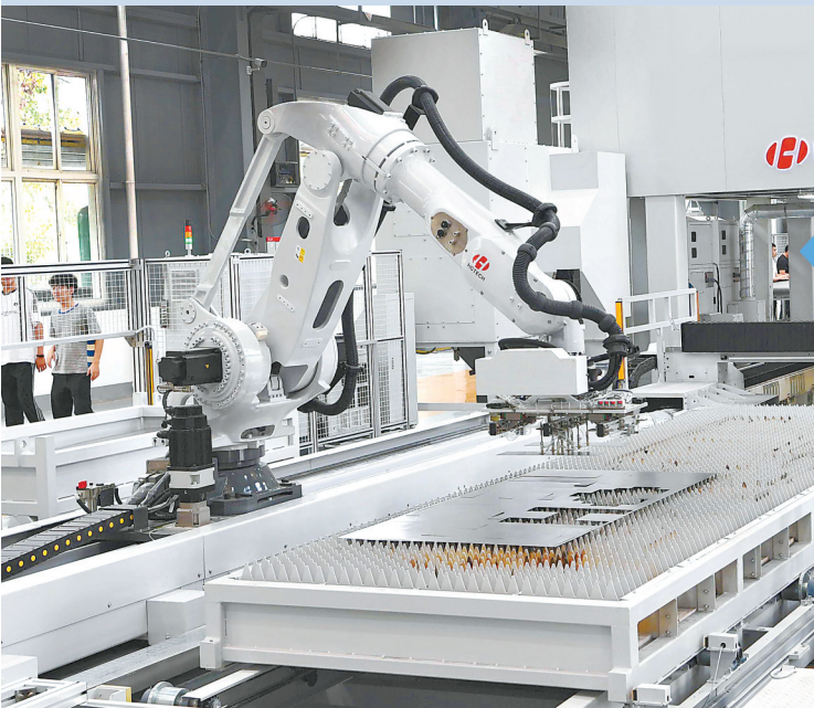
华工科技中试基地，机器手臂灵巧地抓取钢板进行激光切割加工、传递上下料产线演示。
