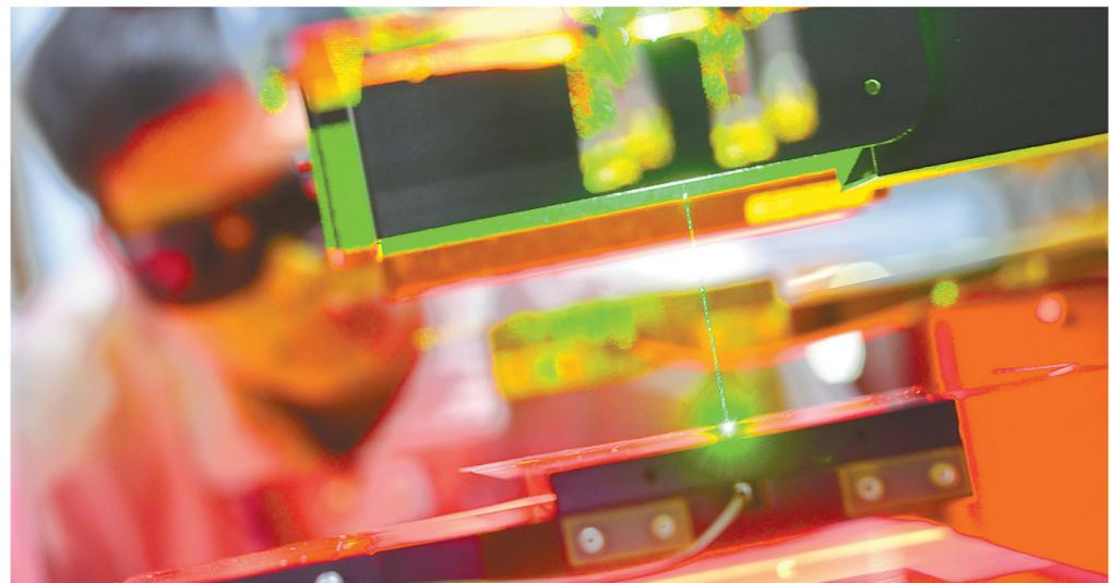
华工激光技术人员在测试载板成品缺陷激光标识设备。
