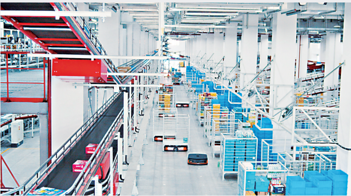
在中百物流的中央仓里,AGV无人搬运车正在工作。
