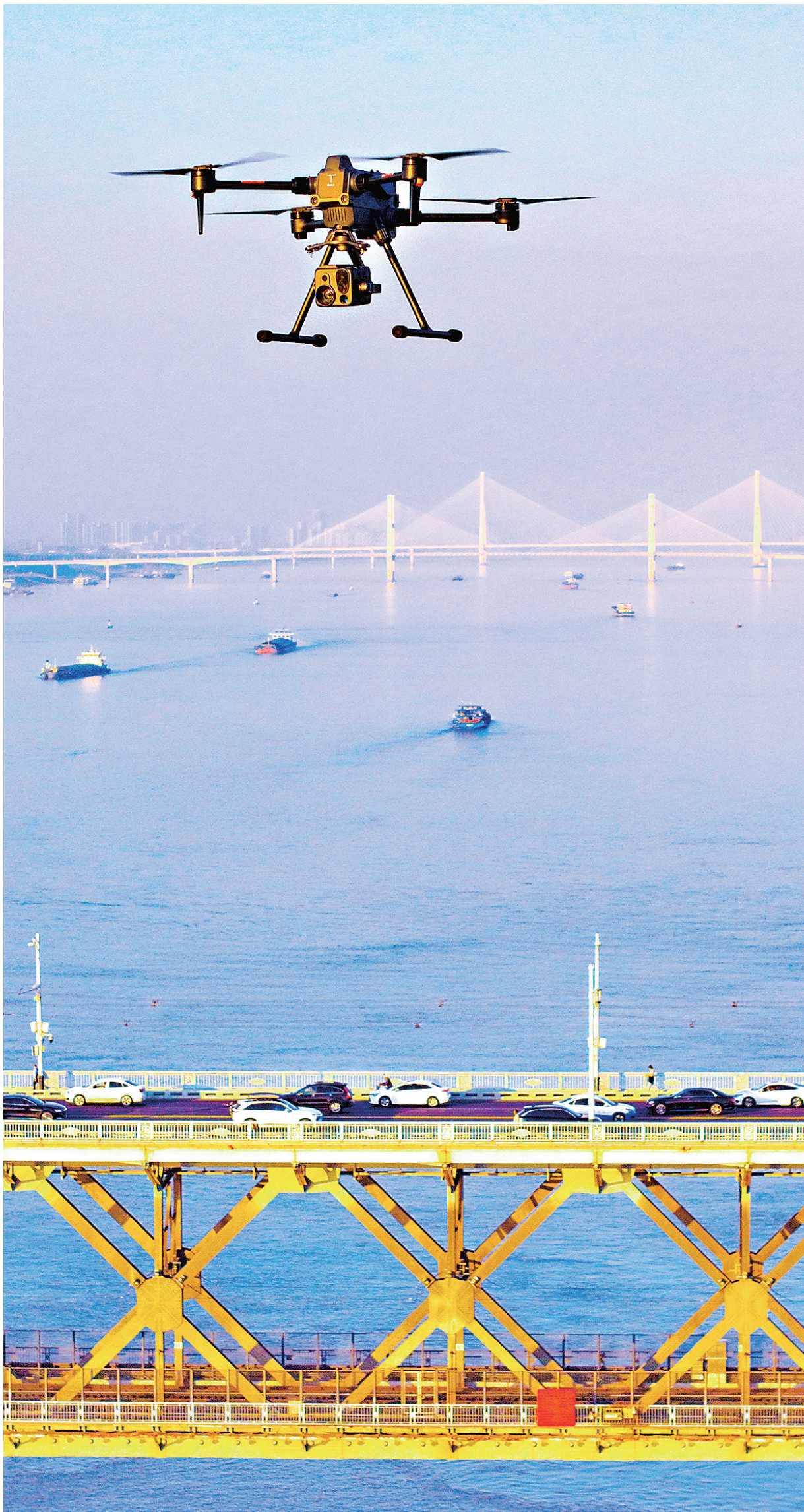
10月25日,普宙科技无人机S400在武汉长江大桥上空往上、下游方向进行测绘、巡检。S400拥有63分钟续航,载重能力达3公斤,可通过一系列自动化技术实现全自主飞行,代替人员控飞和外出作业。
