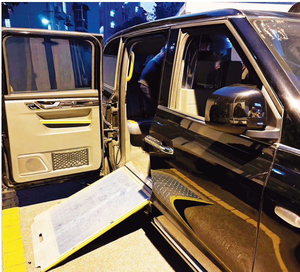
无障碍专车车门从中间向两边打开,配有抽拉式斜坡 踏板,方便轮椅上车。 长江日报记者陶常宁 摄
