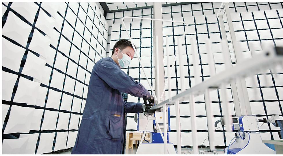
国家光电子信息产品质量检测中心内的10米法电磁兼容实验室能够对CT、雷达等大型设备进行电磁兼容性测试。
