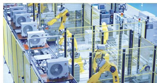
格力暖通全自主设计模块化和高柔性的家电制造生产线。
