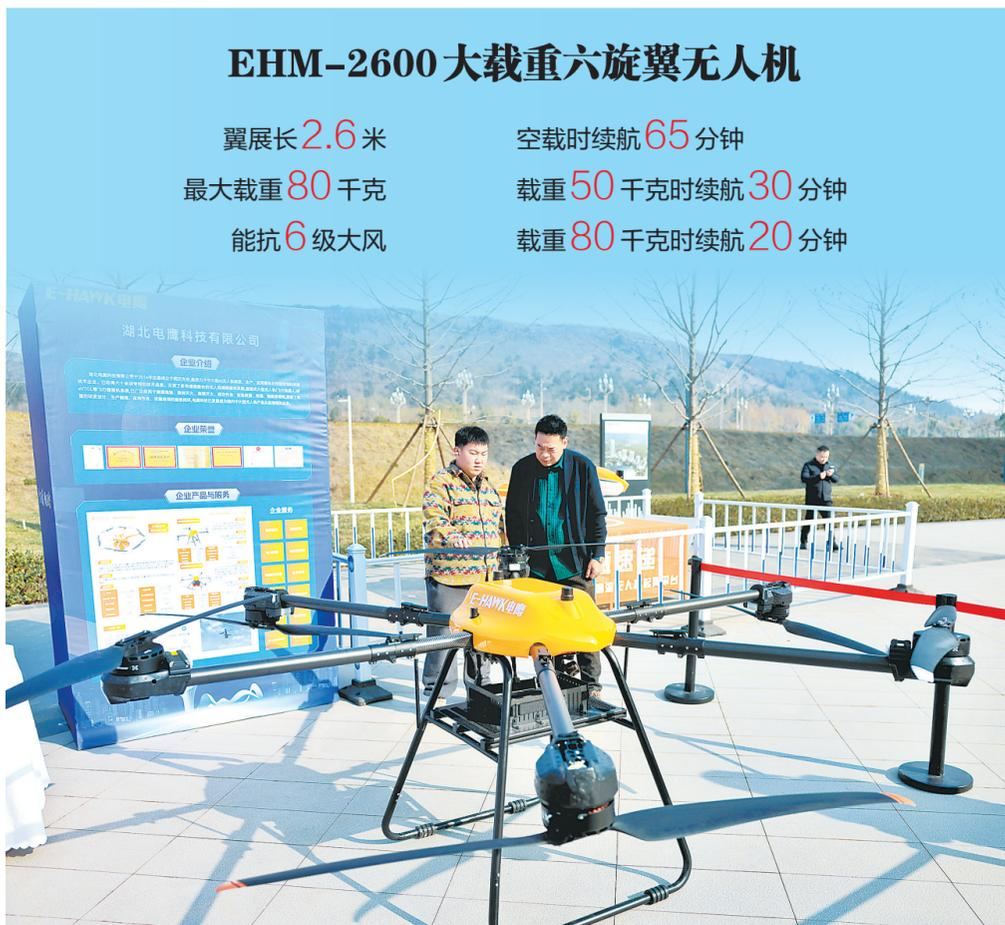
电鹰科技自主研发的EHM-2600大载重六旋翼无人机。
