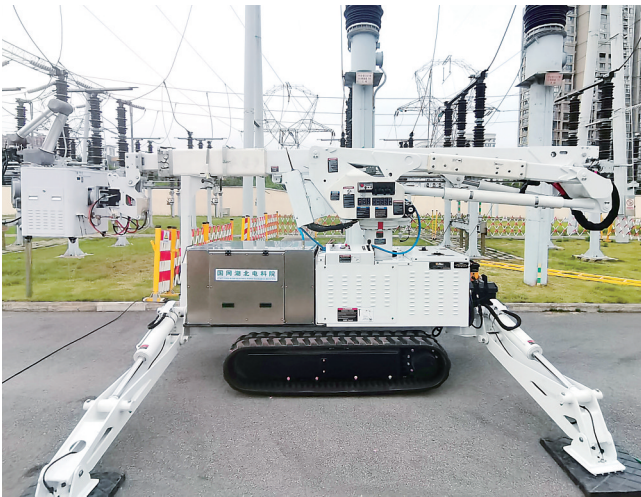
绝缘臂能将机器人送到高压设备附近开展作业。
