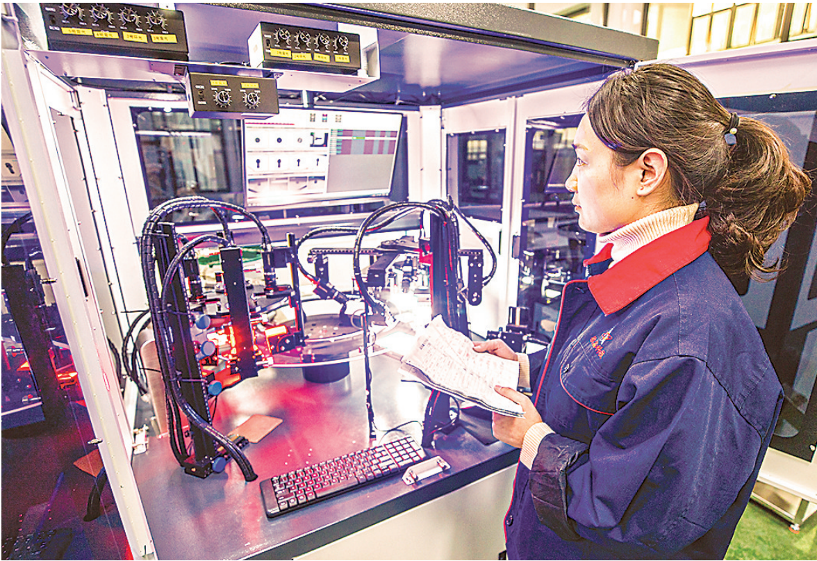
技术人员正在进行关键零部件高温持久检测。
