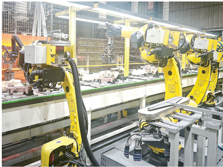
威斯卡特武汉工厂车间,机器人正在进行砂芯芯芯自动化操作。
