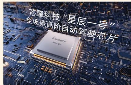
高阶自动驾驶芯片是智能驾驶系统的核心组件,需满足自动驾驶对实时性、可靠性和数据处理能力的苛刻要求。2024年10月,芯擎科技自主研发的高阶智能驾驶芯片“星辰一号”采用7nm车规工艺和多核异构架构,AI算力达512 TOPS,功能安全等级达到ASIL-D等级,能支持L2—L4级别自动驾驶全场景应用算力需求,填补了该算力等级的国产自动驾驶芯片空白。
