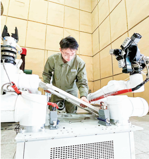
在国网湖北电科院的高压试验大厅,简旭不断调试带电作业机器人设计。 长江日报记者宋磊 摄
