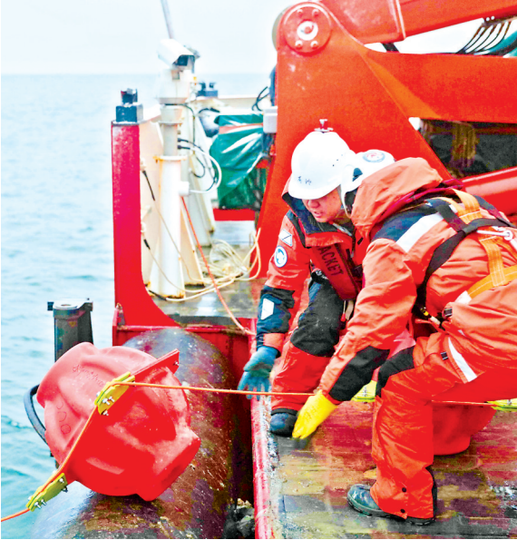
考察队员将潜标放入海中。在海里放置的一年中,潜标将不断收集海洋数据,直到来年被回收。 新华社发
