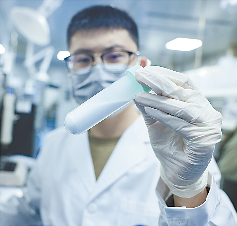
黄学淋展示灭火微胶囊成品,目测如面粉般细小的微粒。 长江日报记者胡冬冬 摄
