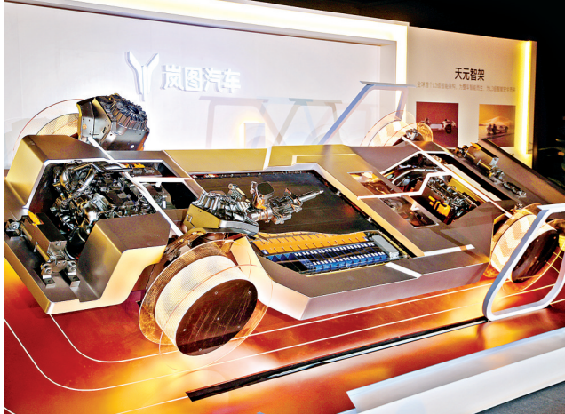
四个电机布局在天元架构中,单个轮子能独立控制扭矩,让岚图新车能在各种空间内流畅丝滑完成原地掉头。
