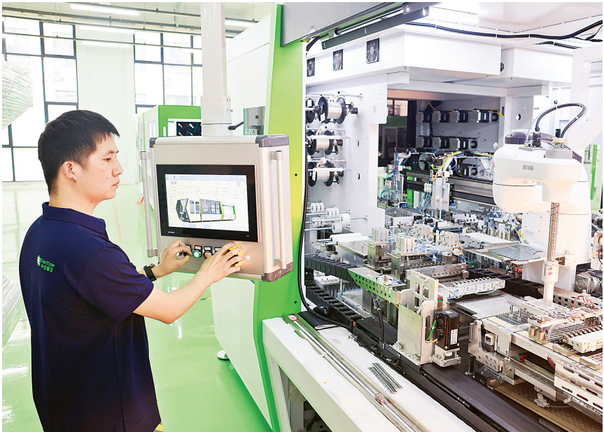
研发人员正在调试高速串焊机设备,测试生产性能。 长江日报记者胡冬冬 摄
