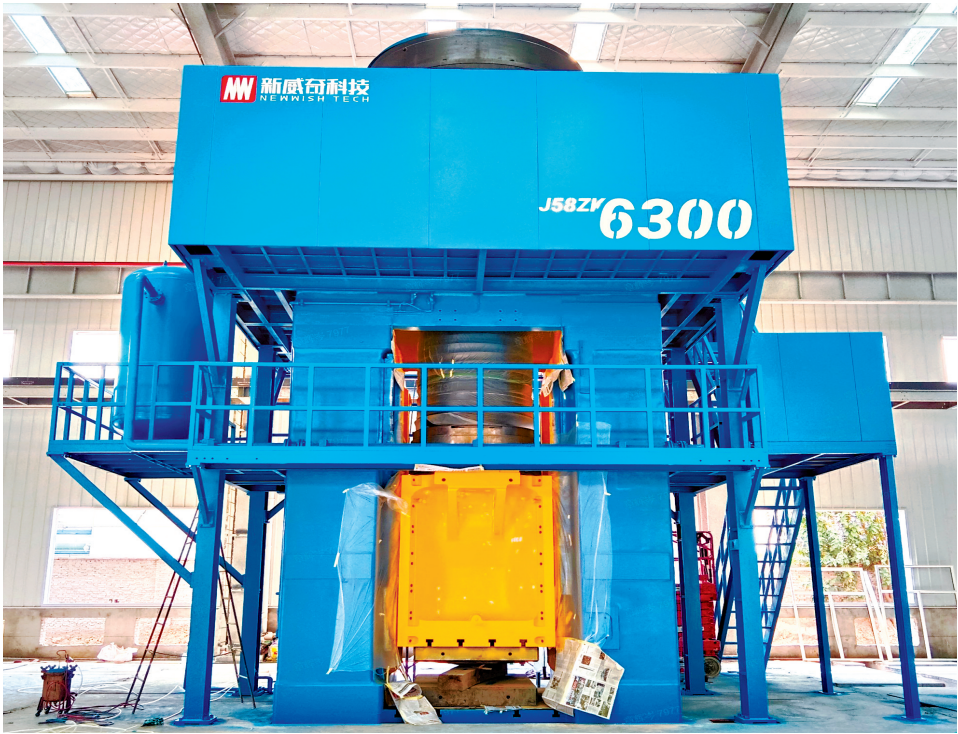
武汉新威奇科技有限公司交付的中国首台、全球最大吨位的6300吨伺服直驱式数控电动螺旋压力机。
