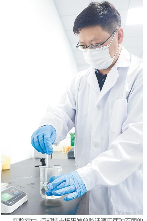
实验室中,迈郝特市场研发总监汪源用两种不同的原料调制的“隧道胶水”刚性环氧树脂。
