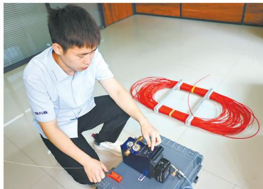
一网万联工作人员利用气吹微管微缆技术,将光纤微缆快速送入微管道。 长江日报记者胡冬冬 摄
