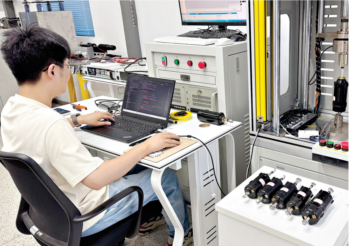
智动力机器人公司研发人员正在对关节模组进行功能完善和性能测试。
