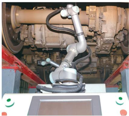
武汉动车段检修库内,一台自带三个机械臂的“大块头”在动车组车底来回穿梭,灵巧地执行动车组车底检修任务(上图)。它是动车组智能巡检机器人,是武汉动车段今年正式投入使用的高科技产品。
