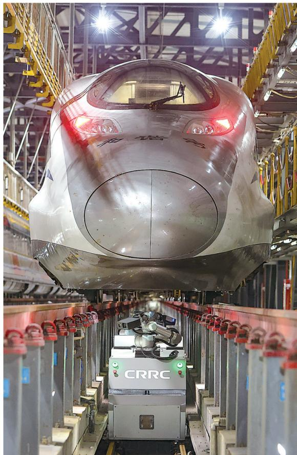
动车组智能巡检机器人在动车组车底来回穿梭。
