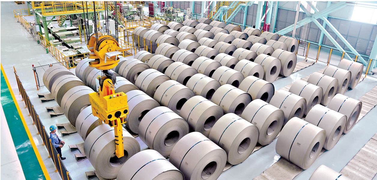
武汉钢铁有限公司硅钢部新能源无取向硅钢分厂“钢卷不落地”的现代物流模式有序运行。
