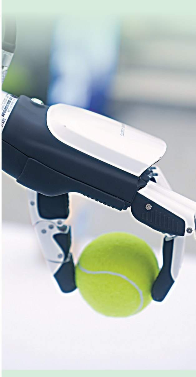
华威研发的“电子皮肤”让机械手拥有灵敏的触觉。 彭年 摄
