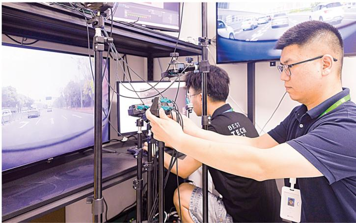
黑芝麻智能应用工程部总监陶星团队调试摄像头，验证华山A1000芯片对车型定制整体方案运行时的稳定性、安全性。 长江日报记者胡冬冬 摄
