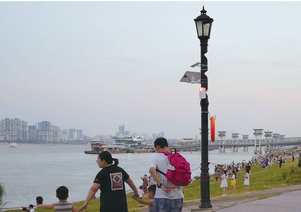
太阳能红外线感应报警器探测到有人靠近江边,发出语音提示。
