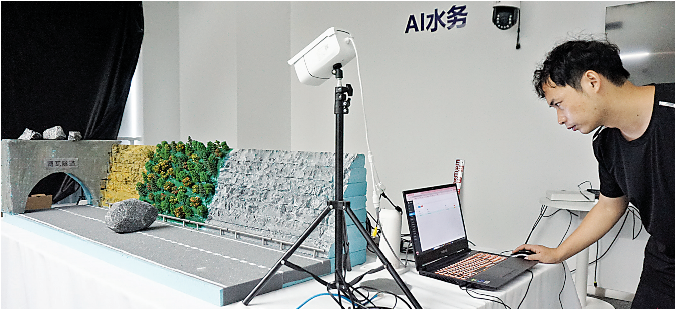
胡亮演示用于检测落石的AI摄像头。
