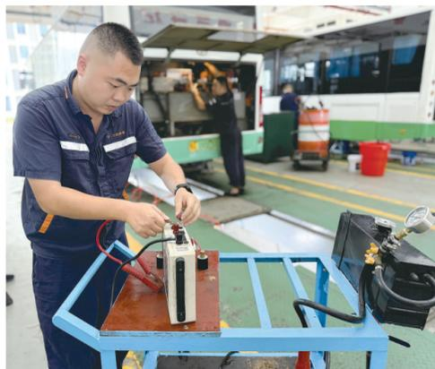
桂伟东正在操作他主导发明的第三代水泵检测台。长江日报记者陶常宁 摄
