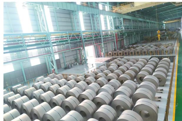
武钢有限新能源无取向硅钢产线。
