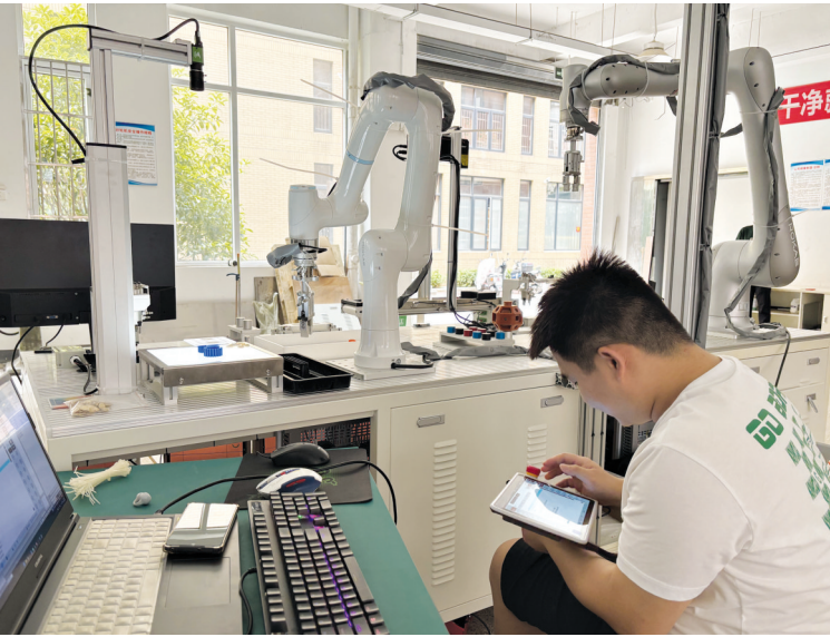
筑梦科技工程师测试研发的机器视觉和工业机器人实训平台。
