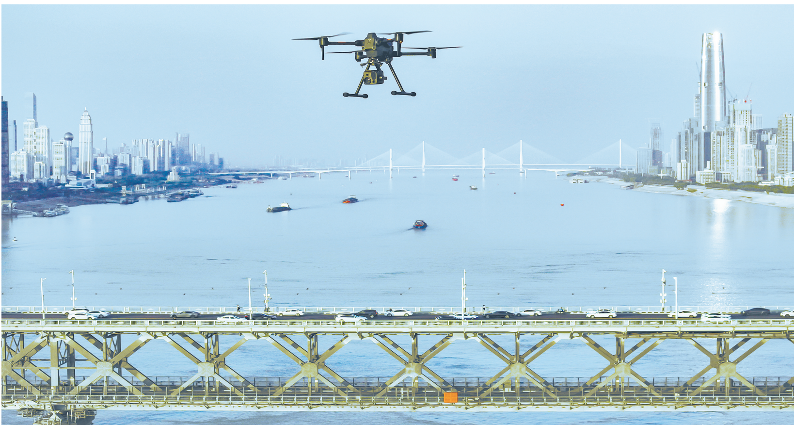
武汉无人机正从“看得见”向“用得”跨越。图为普宙科技无人机S400在武汉长江大桥上空往上、下游方向进行测绘、巡检。
