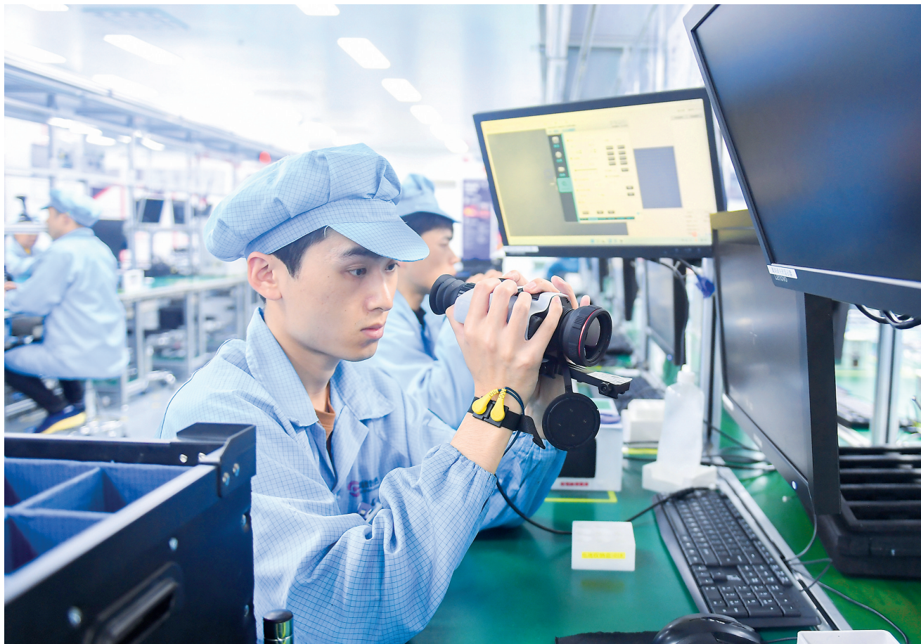
在位于武汉中国光谷的高德红外智能科技产品生产线上,工作人员在对红外热成像仪进行非均匀校正。
