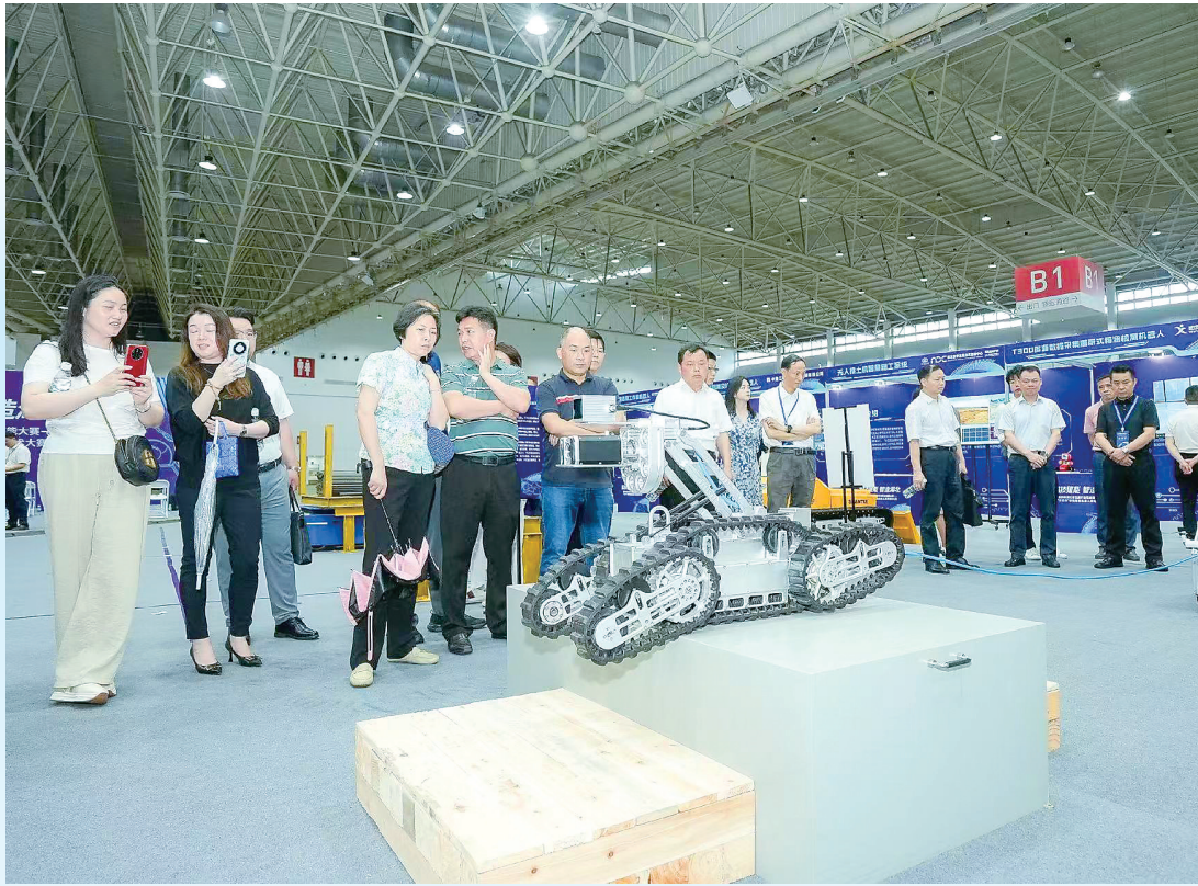
全球首款多形态履带式箱涵检测机器人。
