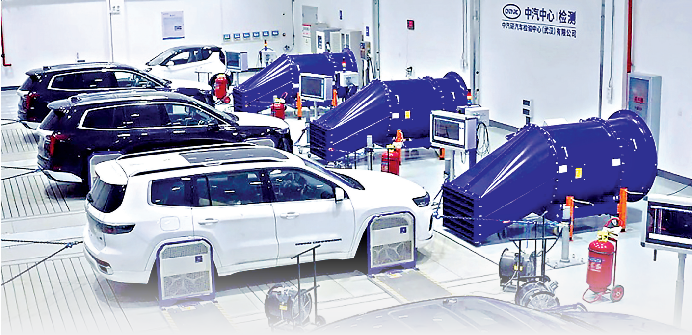
在中汽中心武汉检验中心,车辆正在开展整车耐久性能测试。
