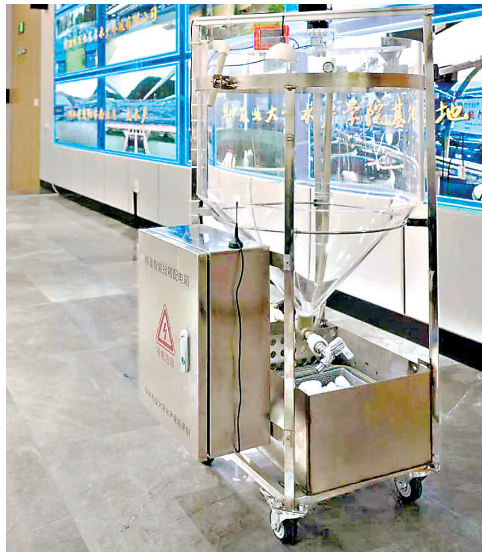
华中农业大学王春芳教授团队研发的智能控制器能根据大数据解析结果发送指令，驱动投料机精准给鱼喂食。 通讯员晏华华 摄
