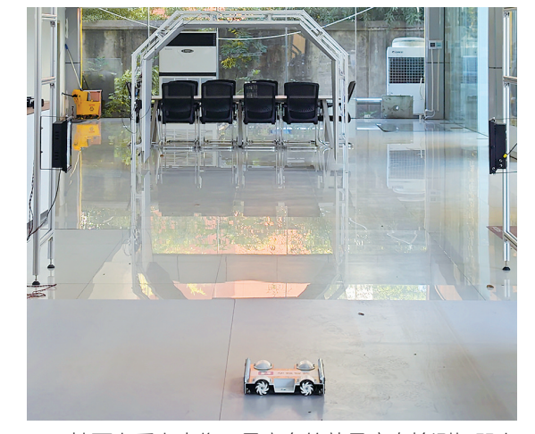
地面上看上去像玩具赛车的就是底盘检测机器人。
