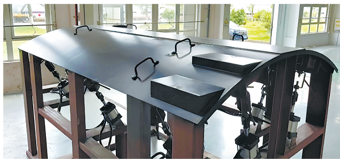
轨道交通货车车辆大丝束碳纤维活动顶盖。
